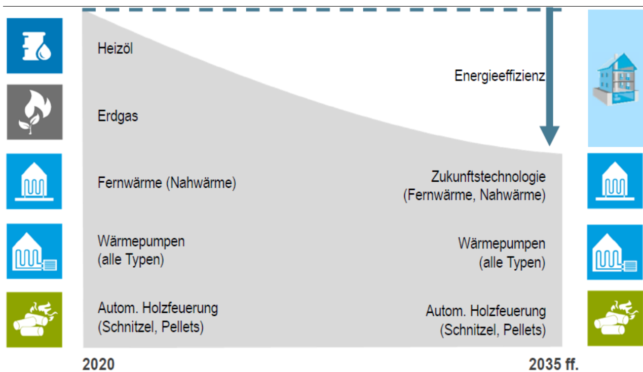
Abbildung 1: Schematische Darstellung der Wärmeversorgung im Kanton Basel-Stadt
